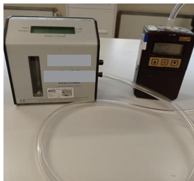
Figura 47 - flussimetro/ contatore volumetrico primario con campionatore a basso flusso
