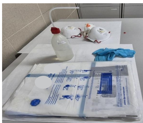
Figure 35 - dotazione necessaria per il prelievo del campione (sx), DPI e acqua per inumidire (dx)
